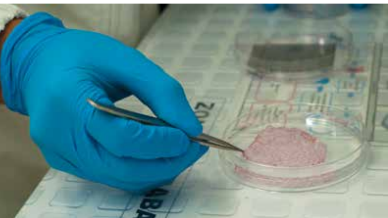
Parches cardíacos constituidos por una matriz de proteína de seda y nanopartículas metálicas, utilizados en el proyecto de investigación.
