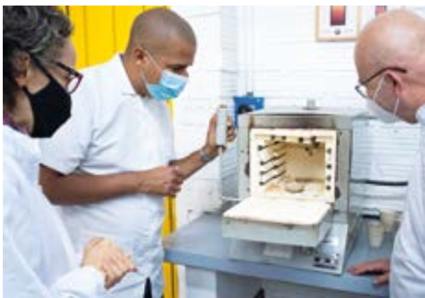
La mufla calienta la madera que, a su vez, derrite el oro.
