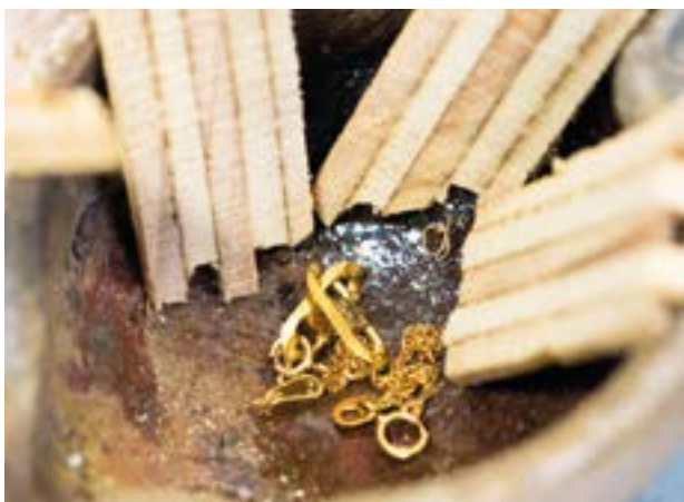
El crisol contiene las joyas de oro y madera.
