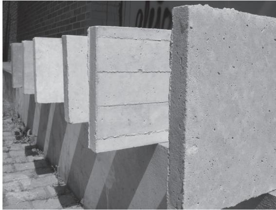
4 y 5. Membranas en Hormigón Reforzadas con Fibras Sintéticas. Investigación desarrollada en el LEET con la Compañía de Empaques.
