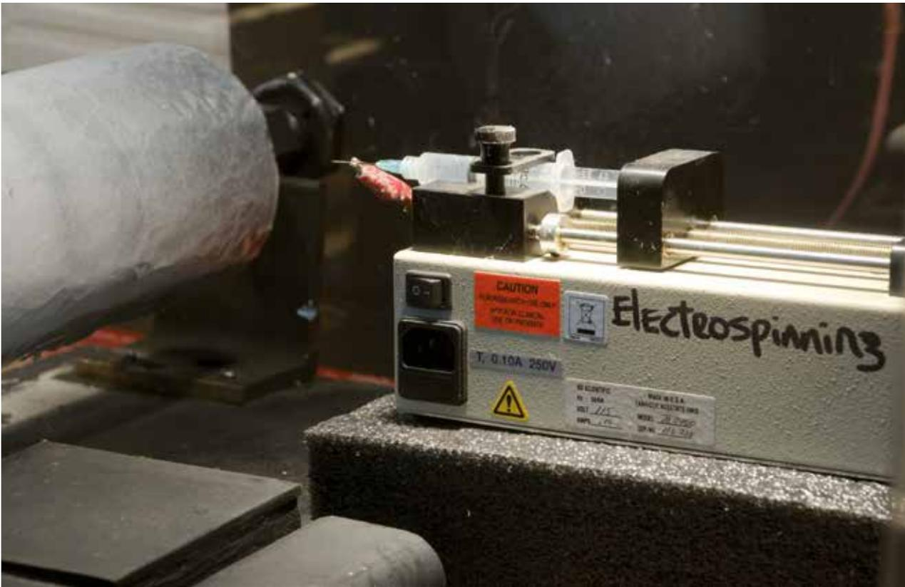
La técnica de *electrospinning* funciona con el mismo principio con el que tejen las arañas, segregar un líquido para originar un filamento.
