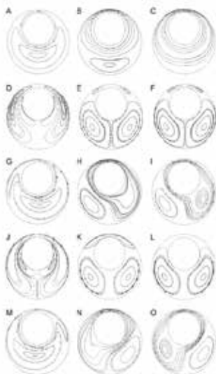
Líneas de corrientes al interior de un mezclador excéntrico Couette con efecto de deslizamiento y transpiración térmica. Autor: César Nieto Londoño.
