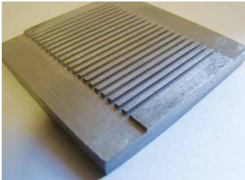
Microceldas de combustible en aluminio para llevar a cabo pruebas de caída de presión y transferencia de calor.
