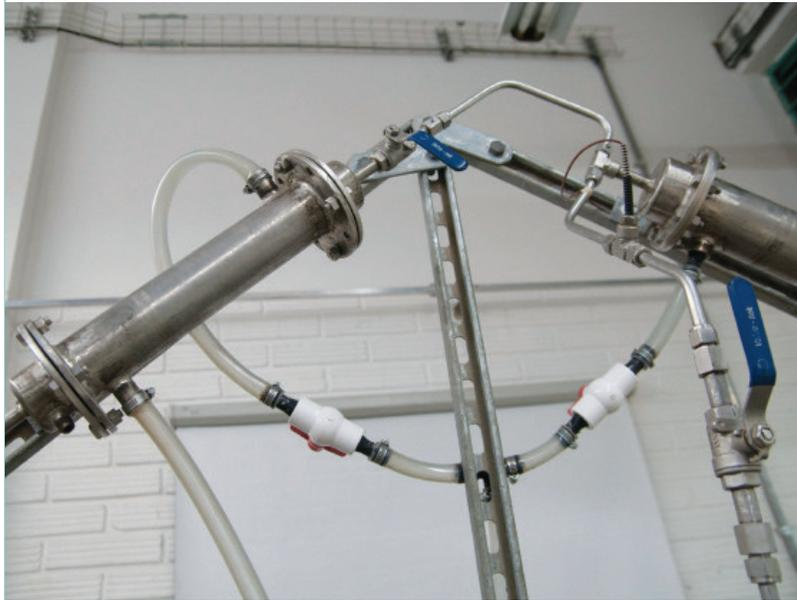
Rectificador y condensador del equipo experimental.
