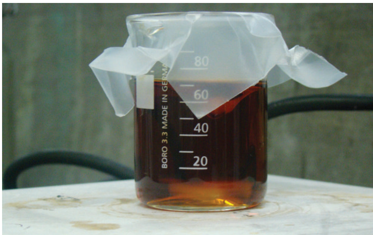
Nanopartículas de magnetita en suspensión o líquido que se utiliza para generar opacidad en implantes poliméricos (aplica para el sector salud).
