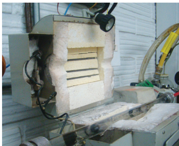
Reactor para producir nanotubos de carbono. Laboratorio de Gases de la UPB - Medellín.
