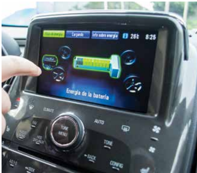
El tablero muestra el flujo de energía y la eficiencia de conducción.
