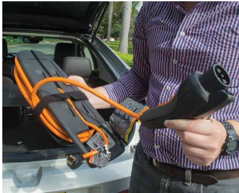
El cargador portátil del vehículo se conecta a cualquier toma convencional.
