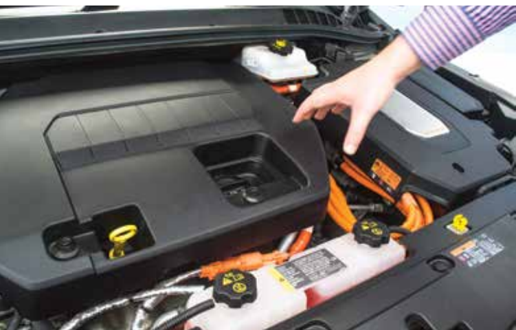
Sistema de extensión de rango: motor combustión + generador.
