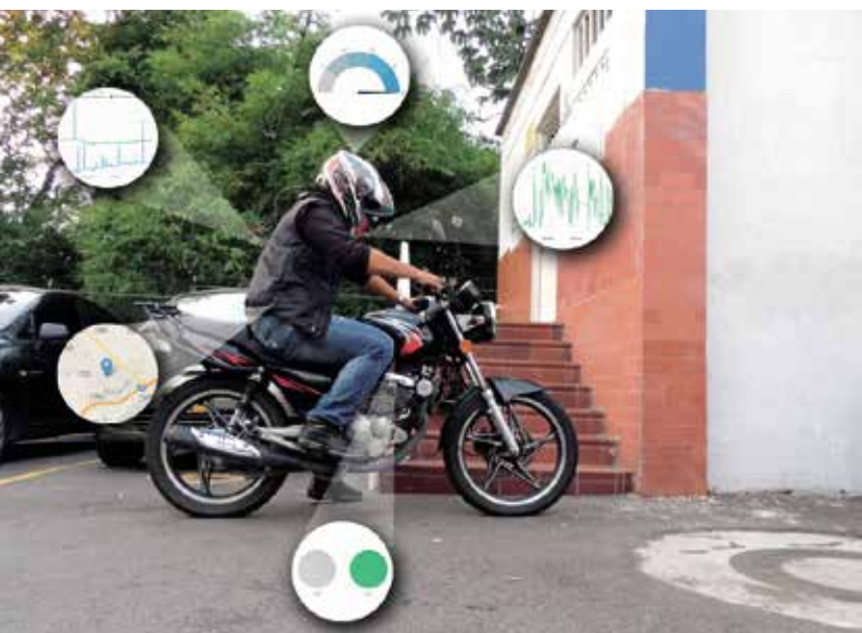
En el momento de un choque, el LLFD obtiene información vital del motociclista con sensores biomédicos integrados al chaleco y al casco. Los íconos representan (en sentido horario): fuerza de impacto en el casco, pulso del motociclista, cambio estructural en la motocicleta, GPS y fuerza de impacto en el tórax.
