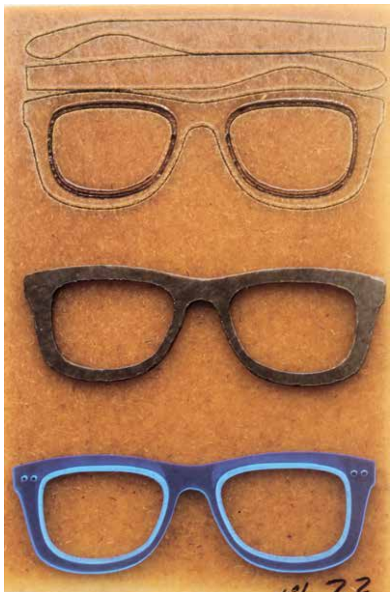
Marco de gafas elaborado con materiales biocompuestos y una matriz biopolimérica.
